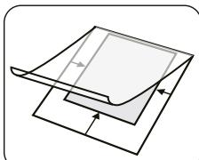
**3** För in den förberedda lamineringsfolien på den driftklara lamineringsappa-tens inmatningssida.
