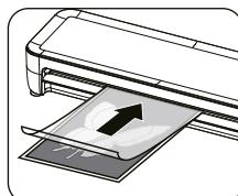
**i** Skala (DIN A4/A5/A6) za foliju za plastifikaciju pokazuje u kojoj poziciji se ta folija za plastifikaciju mora umetnuti u stranu za umetanje.
