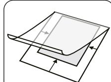
**3** Ввести подготовленную пленку для ламинирования на стороне ввода готового к работе ламинатора.
