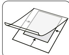
**3** Umetnite pripremljenu foliju za plastifikaciju na stranu za umetanje na laminatoru spremnom za rad.
