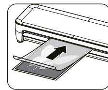
**i** Шкала (DIN A4/A5/A6) для пленки для ламинирования указывает положение, в котором соответствующая пленка для ламинирования должна быть вставлена на стороне ввода.
