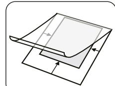
**3** Wprowadzić przygotowaną folię do laminowania na stronę do wyprowadzania gotowego do eksploatacji laminatora.
