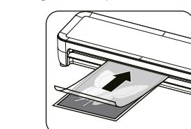
**i** Dimensiunea (DIN A4/A5/A6) pentru folia de laminare indică în ce poziție trebuie introdusă folia de laminare pe partea de introducere.
