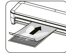
**i** A escala (DIN A4/A5/A6) para a película de plastificação indica, com que posição a respetiva película de plastificação deve ser inserida no lado de entrada.
