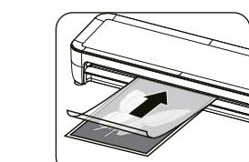
**i** Stupnica (DIN A4/A5/A6) pre laminovaciu fóliu udáva, v akej polohe sa má príslušná laminovacia fólia vkladať do vstupnej strany.
