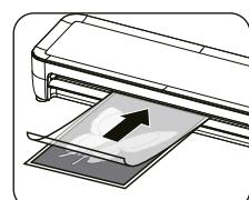
**i** Skalan (DIN A4/A5/A6) för lamineringsfolien anger i vilket läge respektive lamineringsfolie måste föras in på inmatningssidan.
