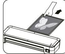
**5** Положить ламинированный материал на ровную поверхность, чтобы он остыл.
